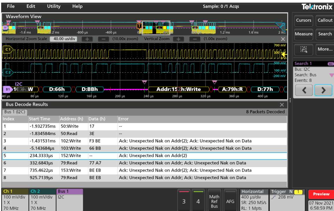
Una forma de onda de bus proporciona paquetes descodificados correlacionados con el tiempo mientras que la tabla de descodificación de bus presenta los distintos paquetes de toda la adquisición, la búsqueda se puede utilizar para navegar
